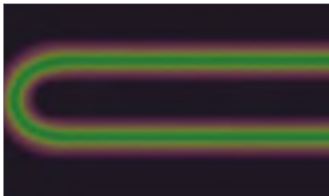
Abb. 9-7 Descoperirea evilor medii de conducere prin folia termică
